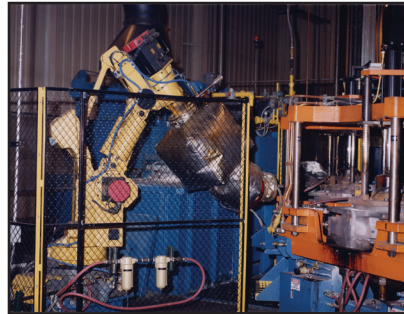
ROBOTIC ALUMINUM POURING
